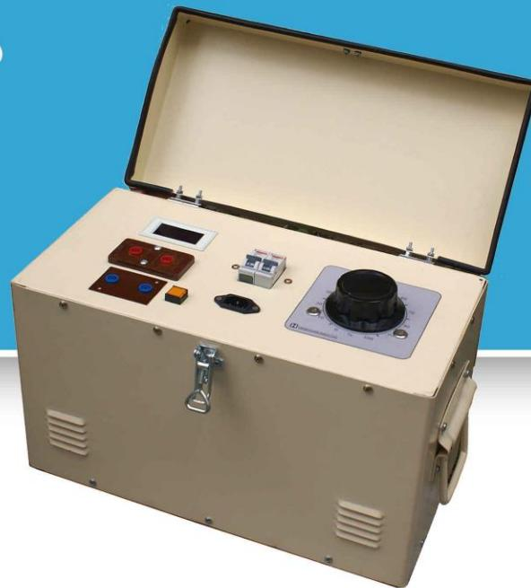
دستگاه تست اشباع ترانسفورماتور مدل HTS103
